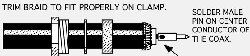
NOTE: USE A FINE FILE TO RUFF UP THE CENTER CONDUCTOR UNDER THE SOLDER HOLE TO IMPROVE THE SOLDER JOINT.
